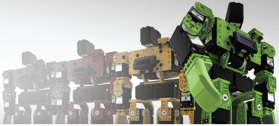
16자유도를 가진 HOVIS의 기본형 모델입니다. 기본적으로 거리 센서, 소리 센서, 조도 센서가 장착이 되어 있으며, 선택 사양으로 Gyro와 Bluetooth 모듈을 조립 후에도 추가로 장착할 수 있습니다. 무엇보다도 초보자도 어렵지 않게 로봇을 조립하고 배울 수 있도록 다양한 매뉴얼과 커리큘럼이 제공되고, 다양한 응용모델에 대한 정보가 제공됩니다.
